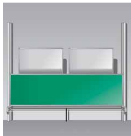
De afbeelding toont twee projectieschermen (elektrisch kantelbaar), gemonteerd achter het bord, met beveiliging tegen het botsen van de borden:
