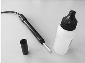
3. Schrauben Sie die gefüllte Kappe wieder auf die Elektrode. Entfernen Sie dabei verdrängte Lösung mit einem Tuch
