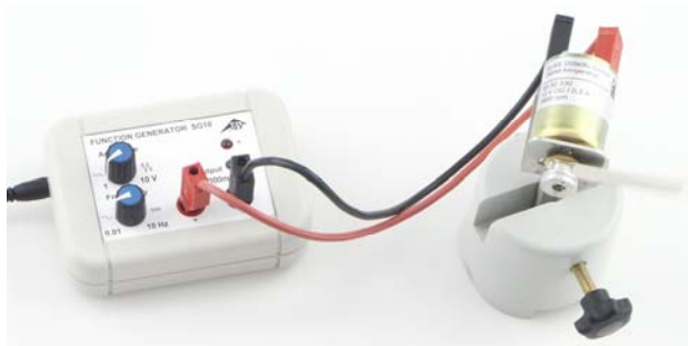
Fig. 1 Montage expérimental pour la démonstration du changement du sens de rotation d'un moteur à courant continu
