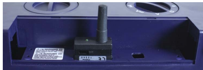
Abb. 6: Eingesetzter Cobra4 Display-Connect
