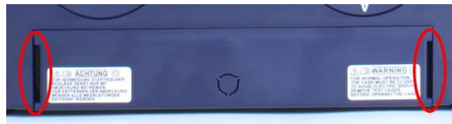
Abb. 5: Schlitz zum Entfernen der Abdeckung
