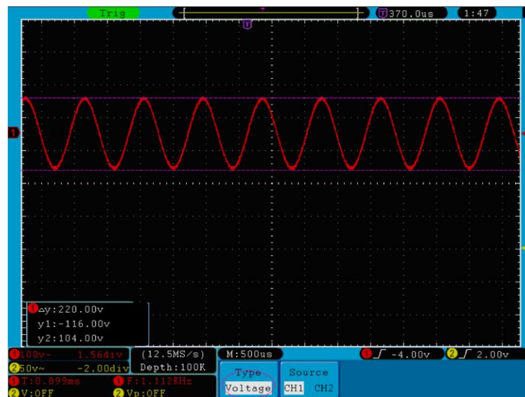
Abb. 71 Wellenform bei der Spannungsmessung mit dem Cursor
