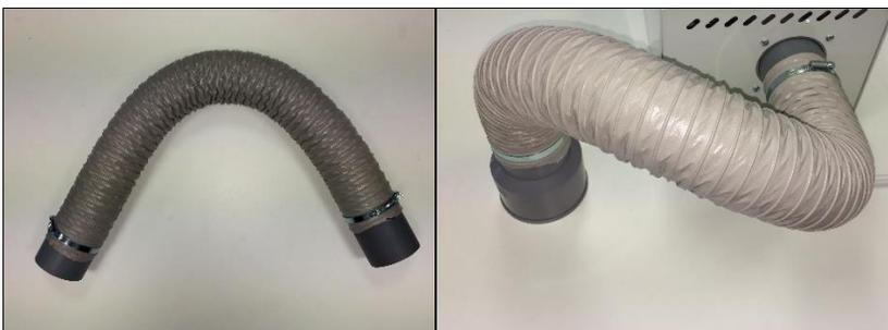
1. Am freien Ende des Anschlussstücks den Adapter für DÜPERTHAL/ASECOS einstecken und mit der mitgelieferten Schlauchschelle fixieren
