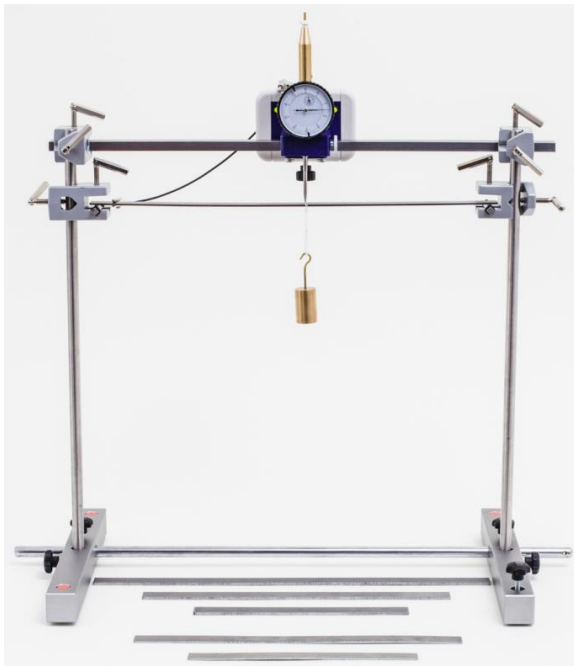
Fig. 1: Experimenteller Aufbau für eine beidseitig gestützte Materialprobe.
