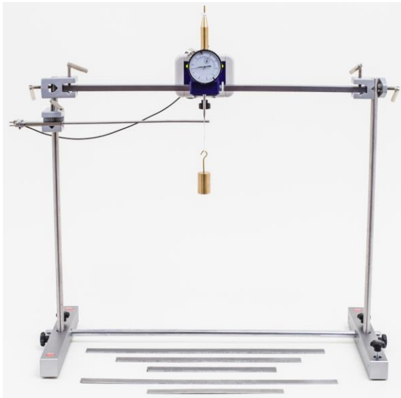
Fig. 2: Experimenteller Aufbau für eine einseitig eingespannte Materialprobe.
