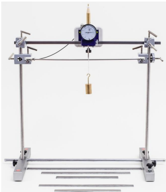
Fig. 1 : Montage expérimental – échantillon matériau en appui sur deux côtés
