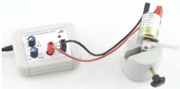
Fig. 1 Experimentieraufbau zur Demonstration der Drehrichtungsänderung eines Gleichstrommotors
