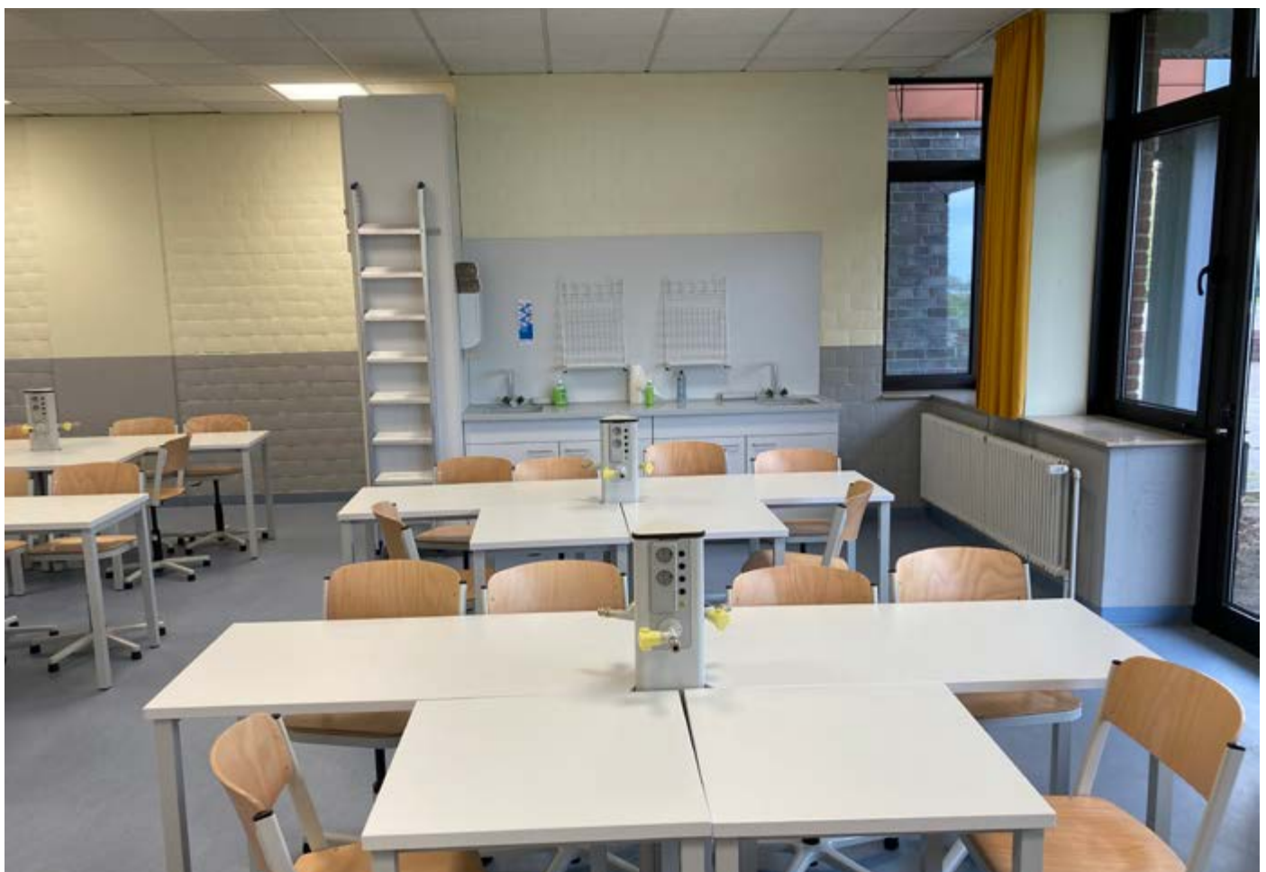
Opstelling waar rij 2 en rij 4 voorzien zijn van een energiezuil. Zo kan rij 1 tegen rij 2 gezet worden en rij 3 tegen rij 4. Dit kan zowel in rechthoekige als in T-vorm.
