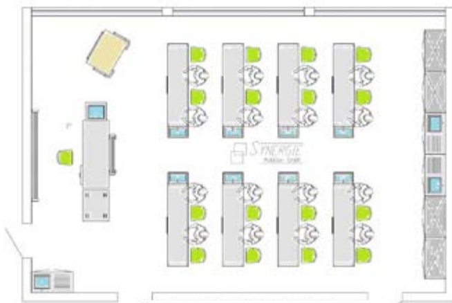
8 systemen, 32 leerlingen, met spoelbak aan zijkant
