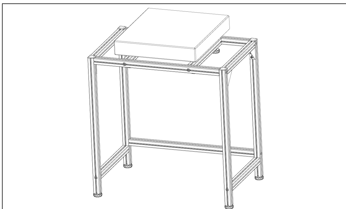
Abb. 6 Montierter innerer Rahmen mit Granitblock
